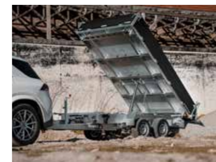
Der HTK kann mit wenigen Handgriffen rückwärts und seitlich abkippen.
