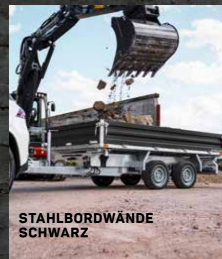
FEUERVERZINKTE STAHLBORDWAND, 400 mm hoch Noch mehr Stabilität für schwere Ladungen
