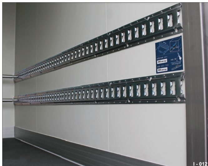
Abb. 22 vastgeschroefd op sandwichwand
