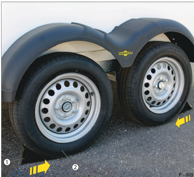
Abb. 4 Wielblokken eronder geplaatst in de parkeerstand
