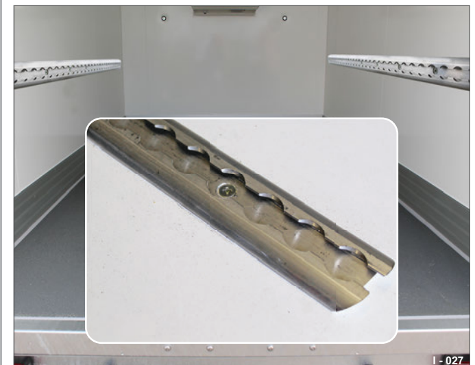
Abb. 26 vastgeschroefd op sandwichwand
