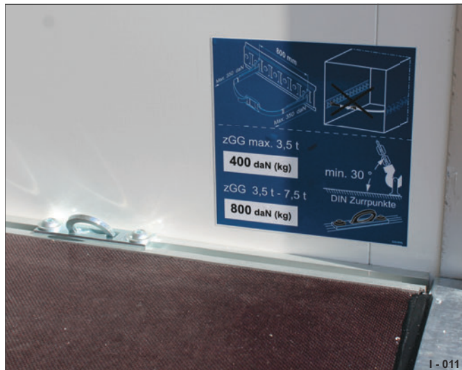
Abb. 21 4 stuks aan elke zijde geïntegreerd in vloerrail
