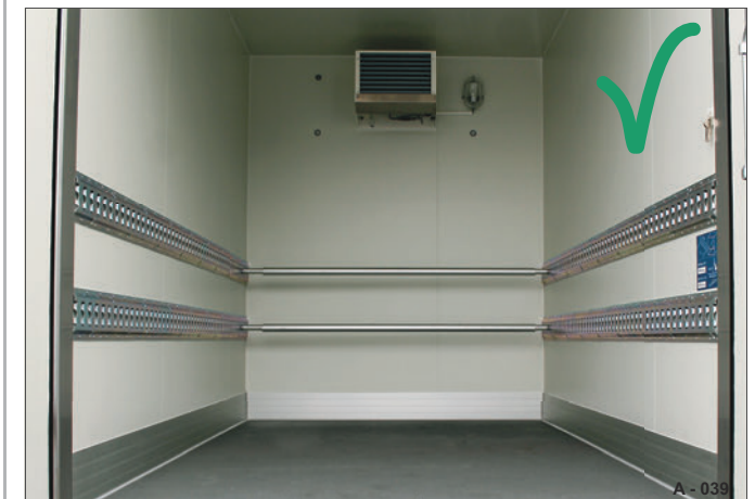
Abb. 39 Vergrendelingsstangen vastgezet (rijstand)
