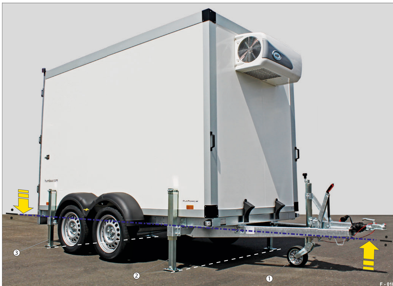
Abb. 17 Koelopbouw aan 4 zijden ondersteund, horizontaal gebalanceerd
