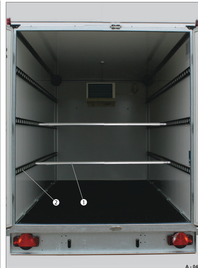
Abb. 48 Vergrendelingsstangen vastgezet (rijstand)
