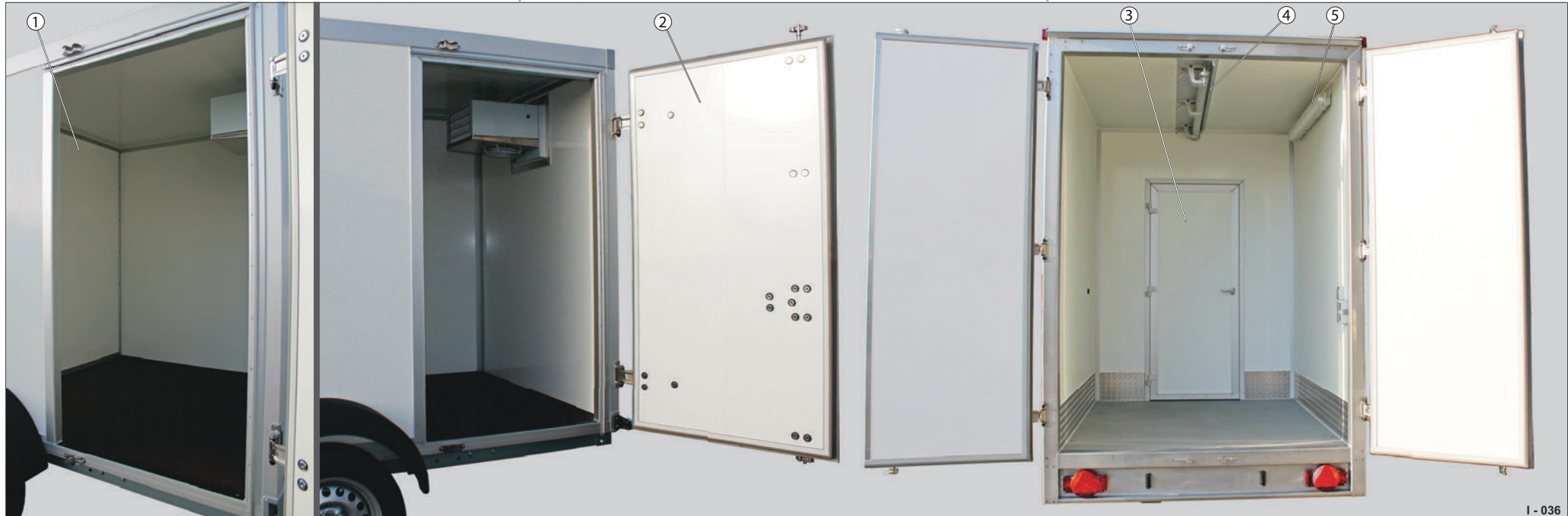
Abb. 38 Tandem-koelopbouw met scheidingswand
