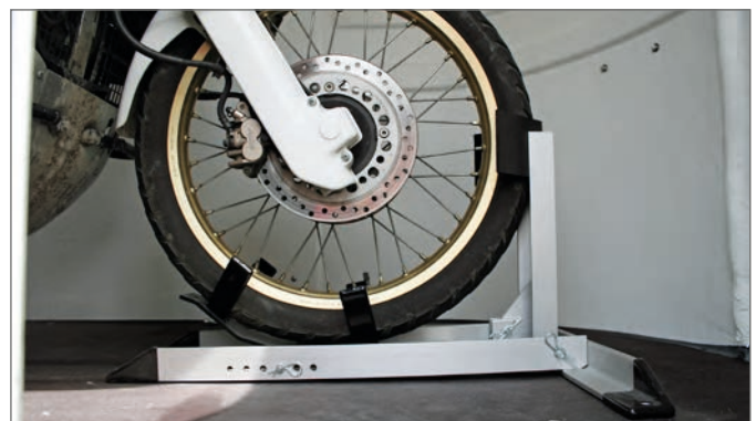
Moto sur le bloque-roue
