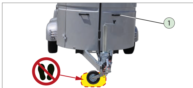
Manœuvre manuelle de la remorque
