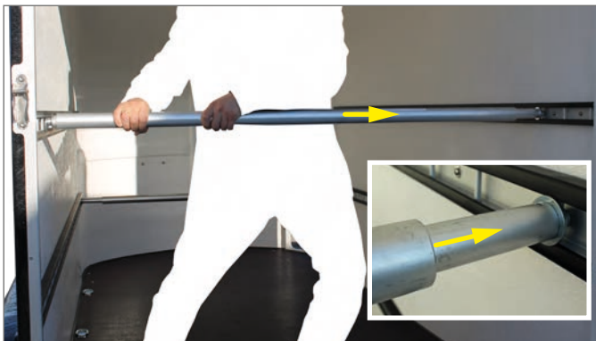
Retrait des barres d'arrimage rondes
