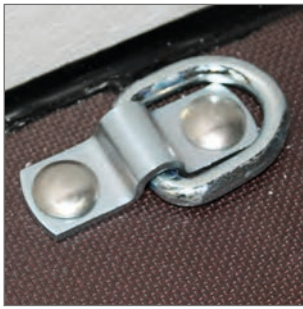
Anneau d'arrimage sur la surface de chargement
