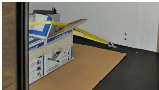
Arrimage correct du chargement
