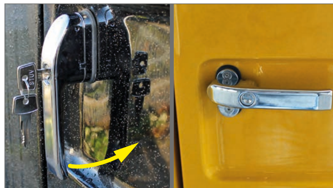
Déverrouillage de la porte d'accès
