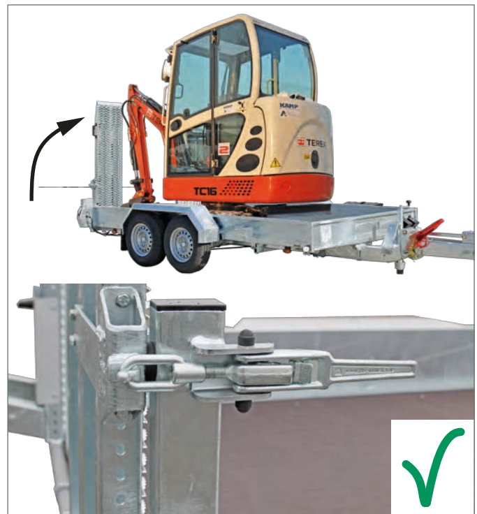
Rampe de chargement fermée et sécurisée
