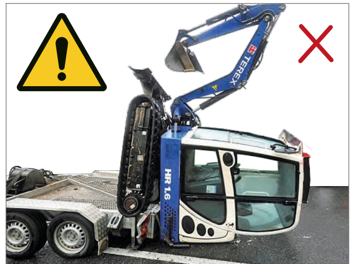
Exemple d'accident (la mini-pelle n'était pas arrimée)
