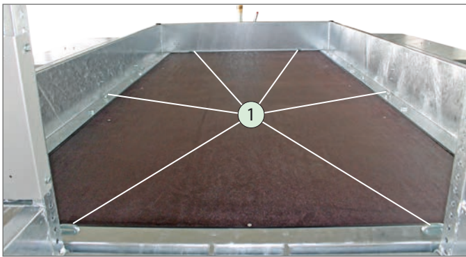
Points d'arrimage - disposition sur la surface de chargement
