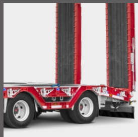
Cadre extérieur galvanisé à chaud et peint en couleur RAL
