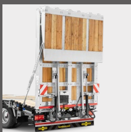
Paroï de passage en 2 parties sur toute la largeur avec Revêtement en planches de bois
