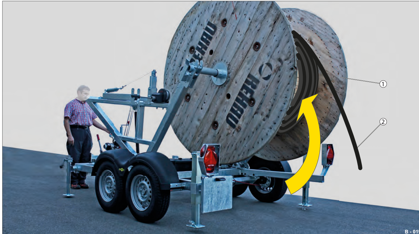
Fig. 16 Løftning af tromlestativ/betjening af kabel
