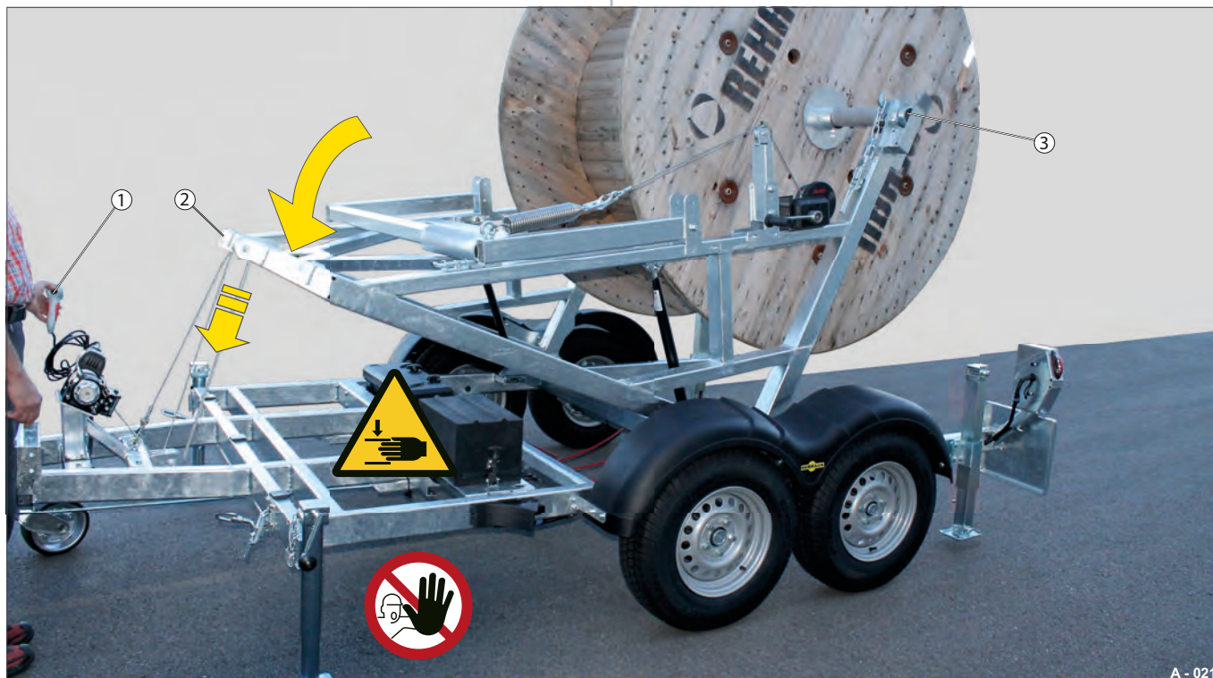
Fig. 12 Tipning af tromlestativet forover
