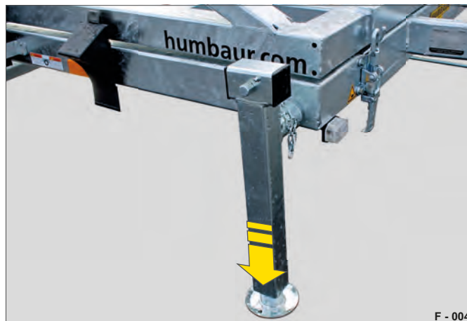
Fig. 4 Teleskopstøtteben med håndsving i støttestilling
