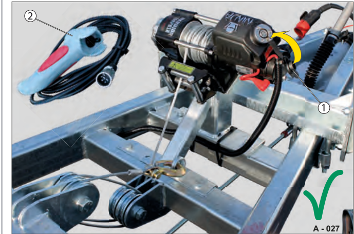
Fig. 18 Elektrisk spil i kørselsstilling
