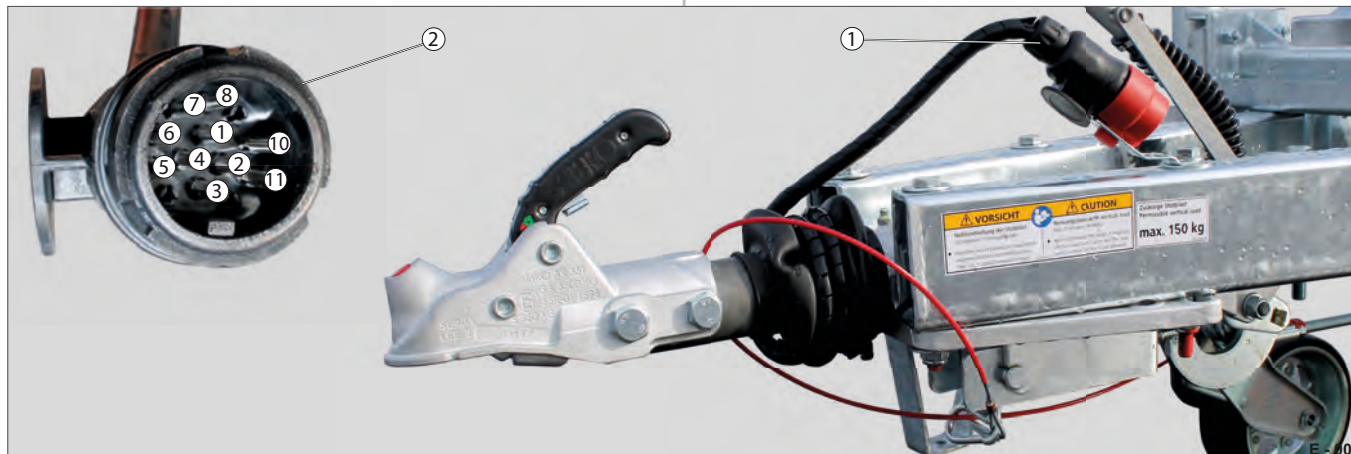
Fig. 3 Stikforbindelse iht. ISO 11466-12 V
