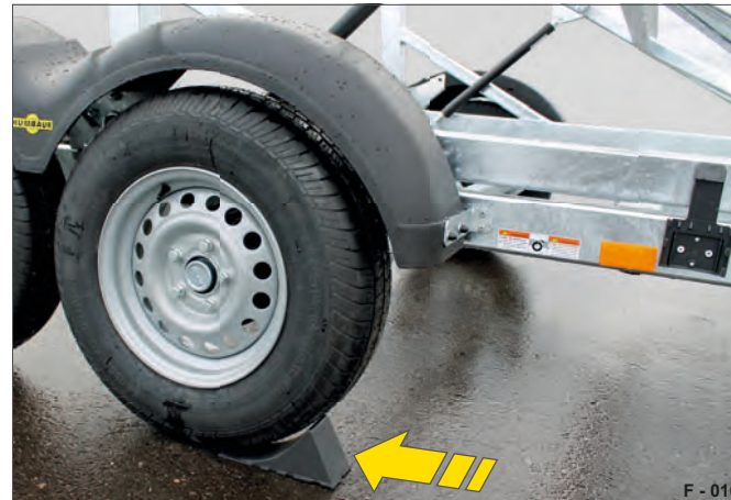
Fig. 10 Stopklodser lagt under i parkeringsstilling
