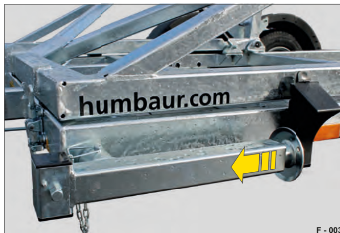
Fig. 3 Teleskopstøtteben med håndsving i kørselsstilling
