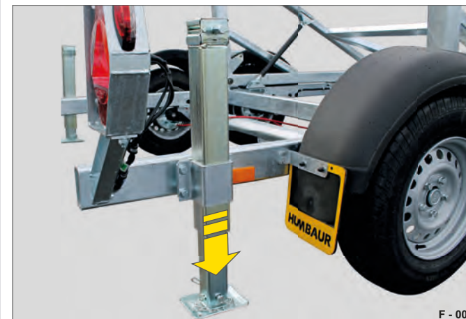
Fig. 6 Teleskopstøtteben med håndsving i støttestilling
