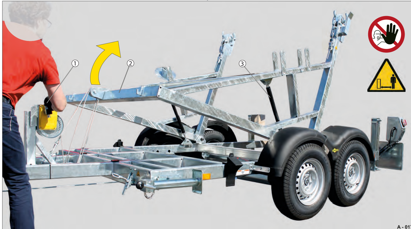
Fig. 8 Tipning af tromlestativet bagover
