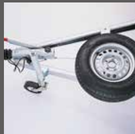
Ersatzradhalter auf Deichsel montiert (nur bei langer Zugdeichsel möglich)
