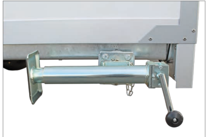
Teleskop-Kurbelstützen in Fahrstellung
