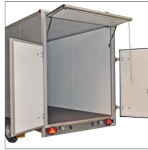
obere Klappe + Doppelflügelige Türe Überfahrwand
