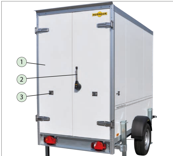
Kühlraumtüre mit Notentriegelung
