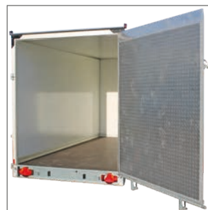
Überfahrwand als Drehtür
