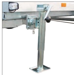
Teleskop-Kurbelstützen, mit Kurbel
