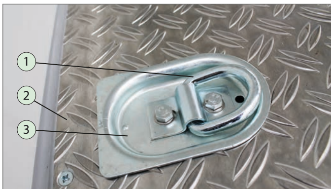
Zurröse in Zurrmulde versenkt (optional)
