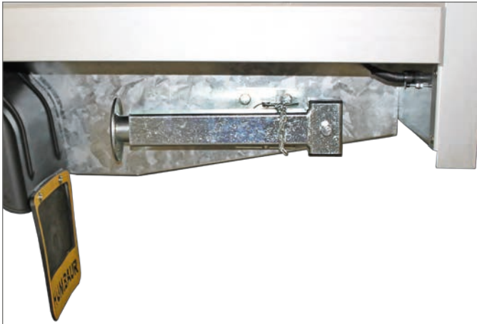
Teleskop-Kurbelstützen in Fahrstellung
