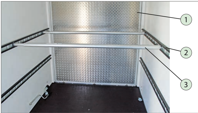
Stäbchenzurrschiene mit eingestecker Sperrstange
