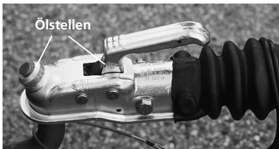
Ölstellen der Kugelkopfkupplung
