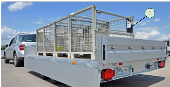
Primer zavarovanja tovora z ujemanjem oblike
