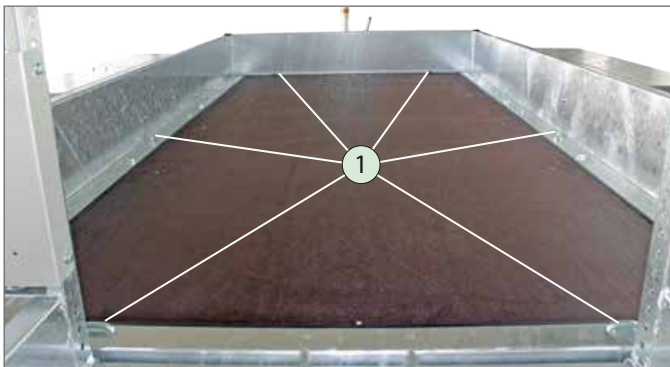
Točke za privezovanje – razporeditev na tovorni površini
