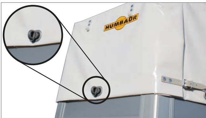
Planenteil frontseitig, Krampe / Schnallen gesichert
