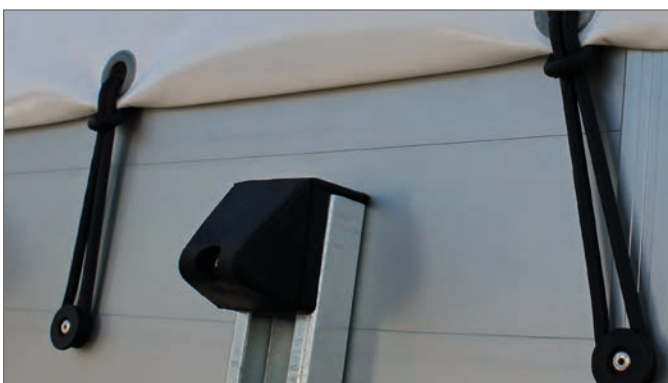
Planenteil heckseitig, Gummizugverschluss gespannt
