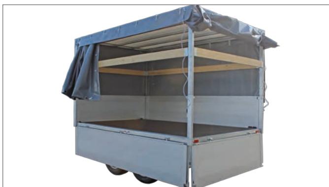
Schiebeplane geöffnet + Bordwand abgeklappt
