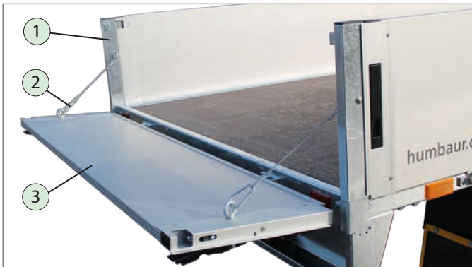
Bordwand mit Auslegeseil gesichert
