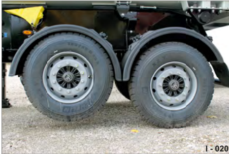
Abb. 10 1-Achse als Liftachse
