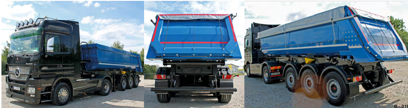
Abb. 20 Zugmaschine mit Mulden-Kipper im Gespann
