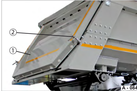
Abb. 27 Heckklappe manuell verriegelt
