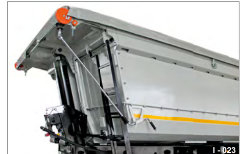
Abb. 15 Schiebeverdeck, mittels Handkurbel betrieben
