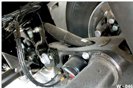
Abb. 53 Membranzyylinder am hinteren Achsaggregat
