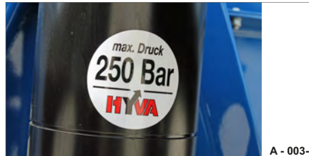
Abb. 5 Beispiel: Hersteller HYVA-GEORG Öldruck-Angabe (Hochdruck)
