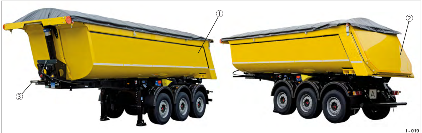
Abb. 3 Thermoisolierter Mulden-Kipper als 3-Achser
