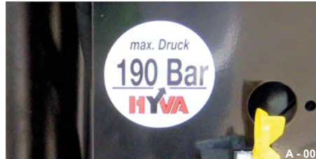
Abb. 4 Beispiel: Hersteller HYVA Öldruck-Angabe (Niederdruck)
