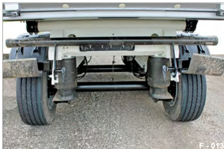
Abb. 38 Unterfahrerschutz oben gesichert
