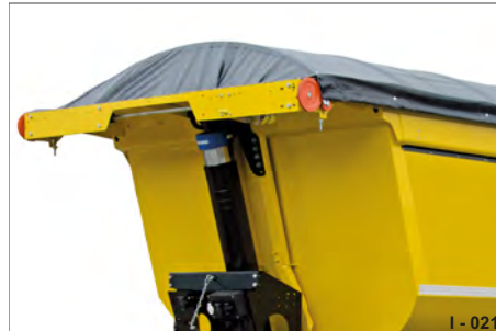
Abb. 13 Vollautomatisches Schiebeverdeck, elektrisch betrieben
