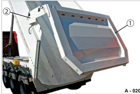
Abb. 24 Heckklappe entriegelt, gehoben
