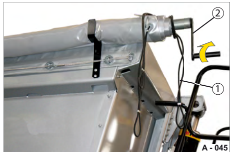
Abb. 56 Rollverdeck vorne entsichert
