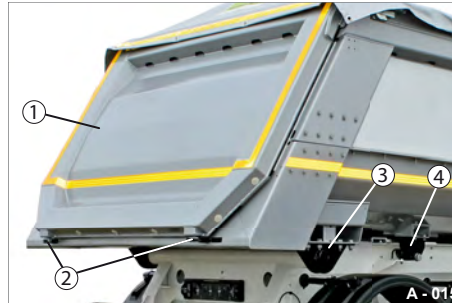
Abb. 19 Heckklappe als Rückwand
