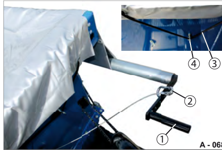
Abb. 59 Rollverdeck vorne gesichert
