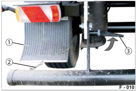
Abb. 35 Unterfahrerschutz entsichert 1 Spritzlappen, befestigt 2 Kette mit Karabiner 3 Federriegel, geöffnet
